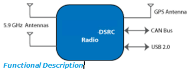
[그림 11] V2V 모듈 회로도: 5.9기가헤르츠 주파수를 통해 필수 운행 데이터를 차량간에 송수신한다
