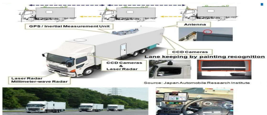
<그림 15> eITS 적용 트럭 군집주행 시스템 구성도
